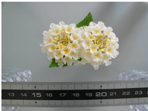
Thước kẻ bị cong khi đưa đối tượng chụp lại gần ống kính khi máy ảnh ở chế độ chụp góc rộng (Wide)
