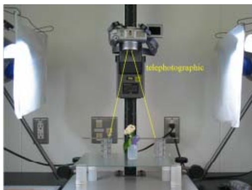
Thước kẻ được chụp thẳng khi đối tượng chụp được chụp ở chế độ Tele (góc hẹp, F lớn)
